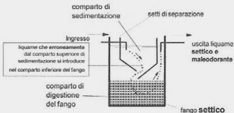
Fig. 6 - Andamento del deflusso del liquame in vasche erroneamente concepite
