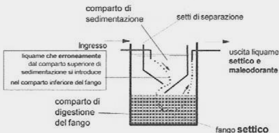
Fig. 6 - Andamento del deflusso del liquame in vasche erroneamente concepite
